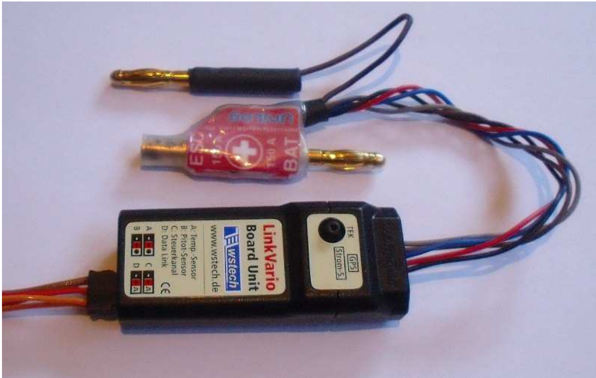
LinkVario mit Stromsensor zur E-Antriebsüberwachung (Strom, Spannung und Kapazität)
